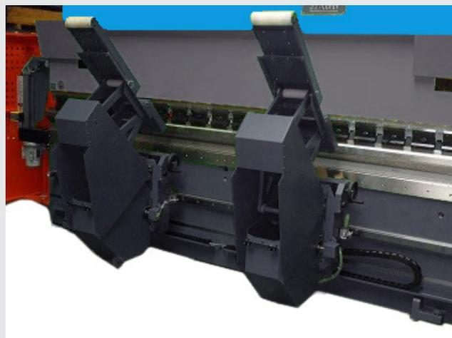
Nos systèmes de maintien électro-mécanique sont équipés de servomoteurs qui permettent de changer la vitesse suivant l'ouverture de V.
